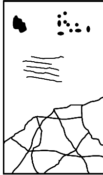
Rys. 6. Schematyczna ilustracja pęknięć powierzchniowych.
